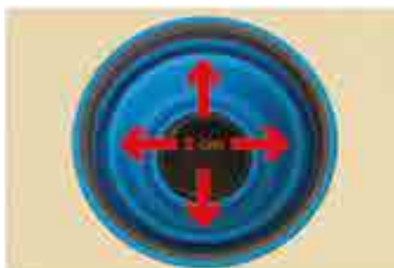
11. Maksimalno odstupanje flex elemtna je 4cm ( \pm 2cm od centra odvoda).
