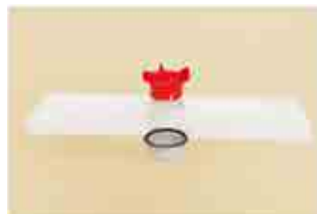
12. Postaviti odvodni ventil u odvodni otvor na kadi i čvrsto ga zavrnuti pomoću montažnog ključa. Zaptivka mora stajati čvrsto u svom ležištu.
